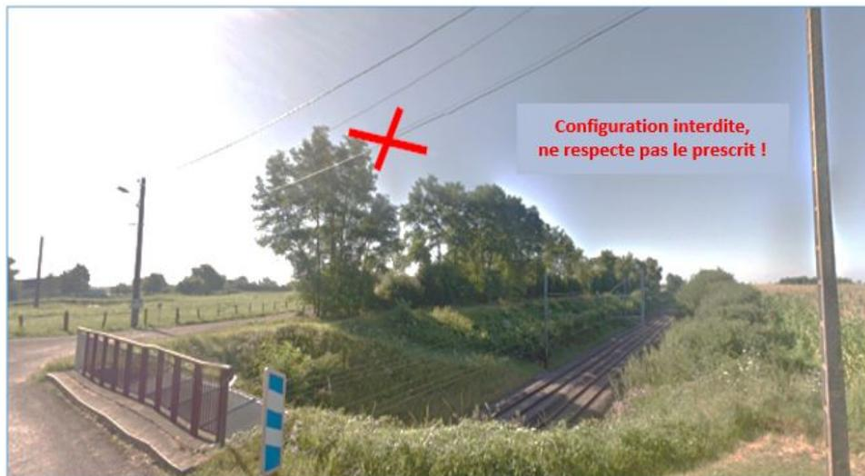
**Rappel** : comme le schéma précédent et la photo ci-dessus l'indiquent, une fibre optique, sur supports communs, ne peut pas surplomber une voie ferrée électrifiée.
